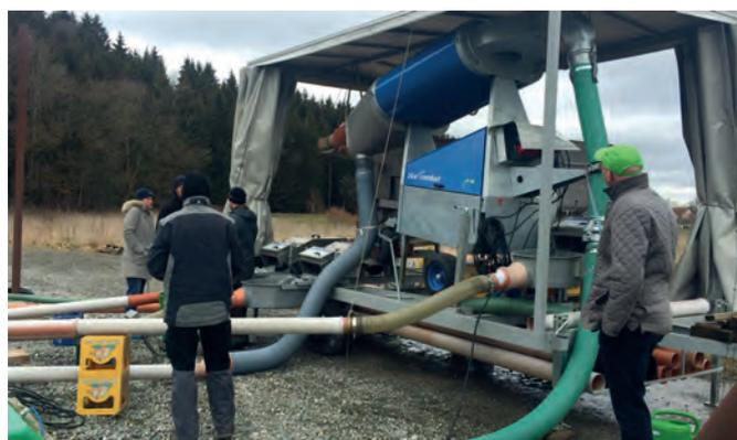
Schonendes Fördern in der Doppelkammer Vakuumpumpe, Sortieren, Zählen und Transportieren von Forellen (Forellenzucht Störk)
