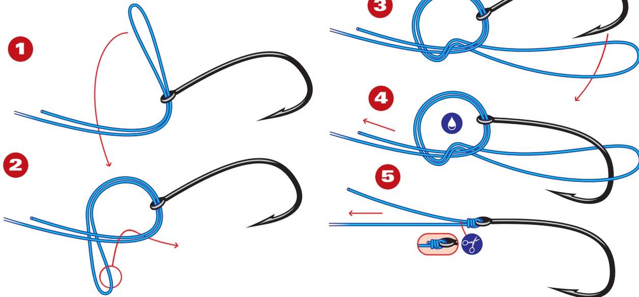
**Der Palomarknoten ist einfach auszuführen und hält den Haken sicher am Vorfach. Gut geeignet für die Anbindung des Öhrhakens ist auch der Plättchenhakenknoten. Bei diesem Knoten muss die Schnur durch das Hakenöhr geführt werden.**
