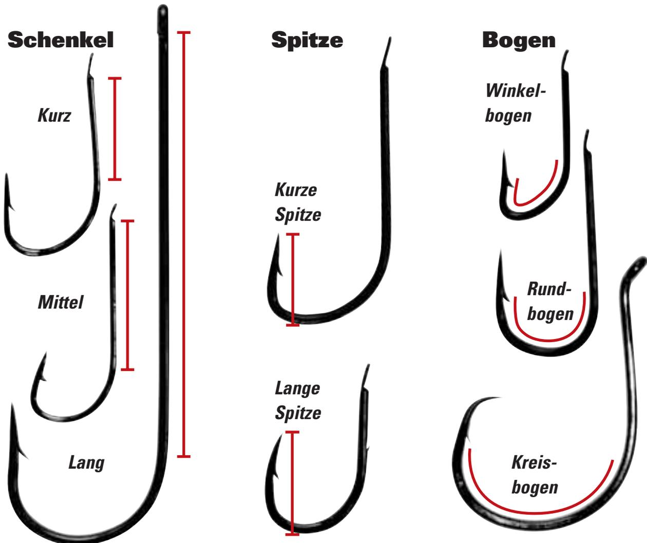
Die verschiedenen Haken-typen unterscheiden sich vor allem nach der Länge des Schenkels, dem Winkel des Bogens sowie der Länge und Form der Spitze. Die Form des Hakens wird dem verwendeten Köder und der Zielfischart angepasst. Kurzschenklige Haken mit weitem Bogen bieten mehr
